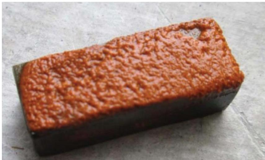
**Gambar 10.** Kembang Karat Pada Uji Spesimen
