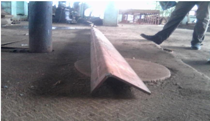
**Gambar 7.** Hasil Pembentukan dengan Mesin Pressing
