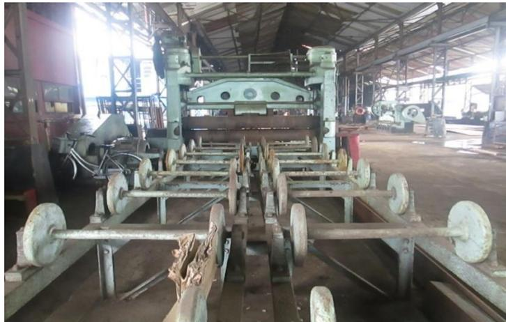
**Gambar 8.** Mesin Roll Dua Tingkat
