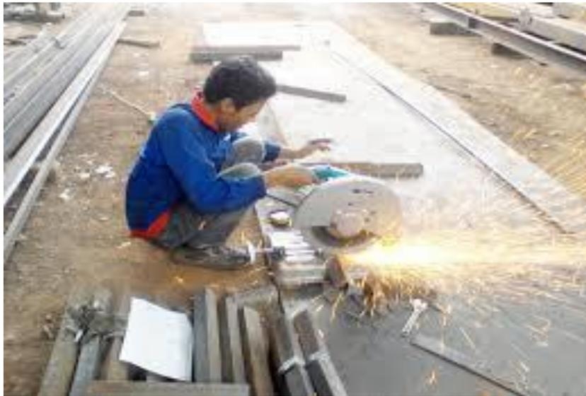
**Gambar 4.** Pemotongan Plat Pada Gerinda
