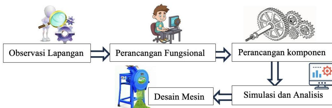
Gambar 1. Diagram alir tahapan perancangan mesin pencacah pakan ternak.
