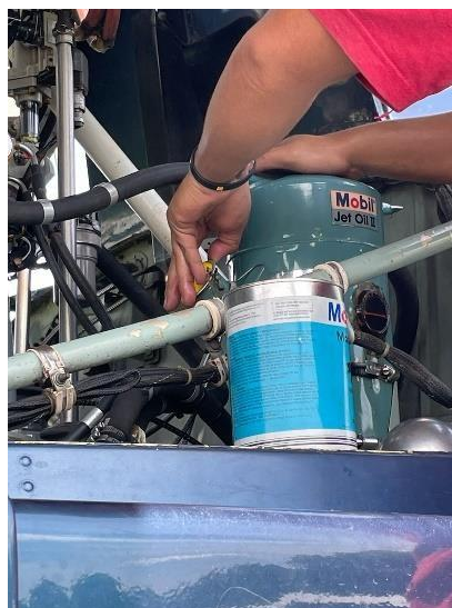
Gambar 3. Proses pengisian oli pada engine Lycoming O-540
