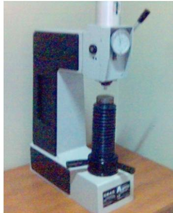
**Gambar 4.** Alat Uji Kekerasan *Rockwell*
